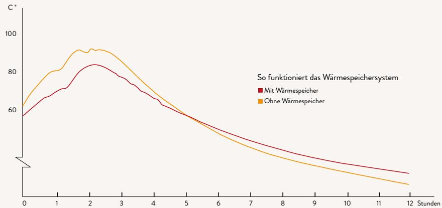
Die Olivinsteine im Wärmespeichersystem halten die Wärme und geben sie gleichmäßig ab. Die Diagramm-Kurven zeigen den Effekt im Vergleich.
