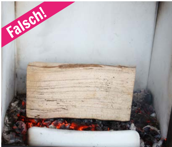
Falsches Nachlegen bei einem Kaminofen Kein Nachlegen nur eines Scheits!
