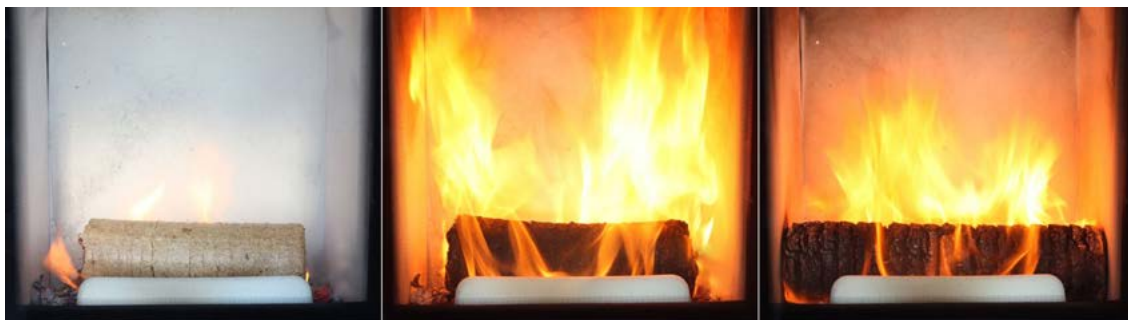
Ausdehnung von Holzbriketts im Feuerraum: Die Briketts werden eingeklemmt und können den Kontakt zum Glutbett verlieren (Hohlbrand!). Daher müssen sie vorher auf eine passende Länge gebrochen werden.
