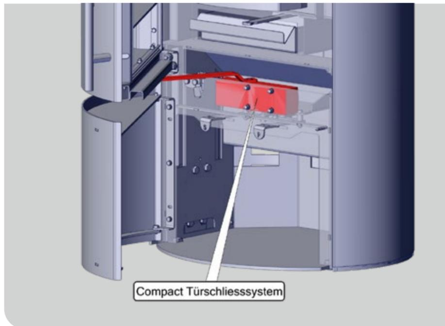
Die Öfen mit dem Compact-Schließsystem verfügen über eine bauaufsichtliche Zulassung sowohl für raumluftunabhängigen als auch für raumluftabhängigen Betrieb. Beim Einbau mit einer zugelassenen Lüftungsanlage ist bei raumluftunabhängigem Betrieb keine zusätzliche Sicherheitseinrichtung erforderlich.
