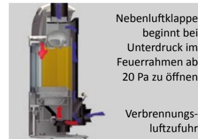
Nebenluftklappe beginnt bei Unterdruck im Feuerraum ab 20 Pa zu öffnen
