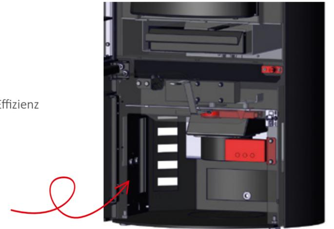
Der eingebaute Sensor kontrolliert fortlaufend die Temperatur im Abgas und leitet die ermittelten Daten umgehend an den Prozessor der Regeleinheit weiter, der daraufhin einen Abgleich mit den gespeicherten Idealbedingungen vornimmt. Die Verbrennungsluftmenge wird mit dem installierten Stellmotor, passend zu jeder Abbrandsituation, optimal geregelt. Am Ende des Abbrandes (Grundglutphase) schließt der OEC die Luftzufuhr und verzögert so ein Auskühlen des Aufstellraumes.
