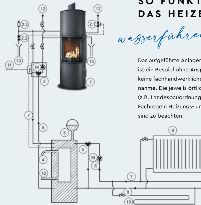
1 Kaminofen 2 Kompletsteuerung 2.1 Thermische Ablaufsicherung 2.2 Sicherheitsventil 2.3 Schnellentlüfter 3 Ausdehnungsgefäß 4 Warmes Brauchwasser 5 Wechselventil 6 Pumpe 7 Vorlaufleitung 8 Rücklaufleitung 9 Heizkörper 10 Fußbodenwärme 11 Netz 230 V/ 50 Hz 12 Frischwasser 13 Abfluss
